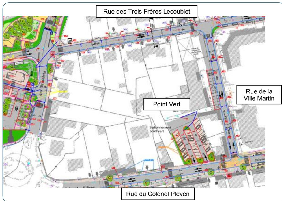
Depuis juin, la réfection des chaussées des rues de la Ville Martin et des trois Frères Lecoublet a commencé par l'effacement des réseaux électriques et téléphoniques, et la mise en place de deux réseaux pour l'évacuation des eaux usées et des eaux pluviales. Ils seront suffisamment dimensionnés pour tenir compte de l'évolution des besoins.
